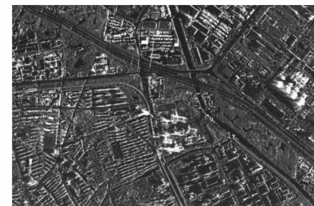
Image obtenue par le satellite TerraSAR-X, où chaque pixel correspond à la réponse de l'objet scanné par effet Doppler des micro-ondes émises par le radar. L'échelle de l'image d'origine est d'un mètre par pixel, et je travaille le plus souvent sur des zones couvrant plus de 400km².
